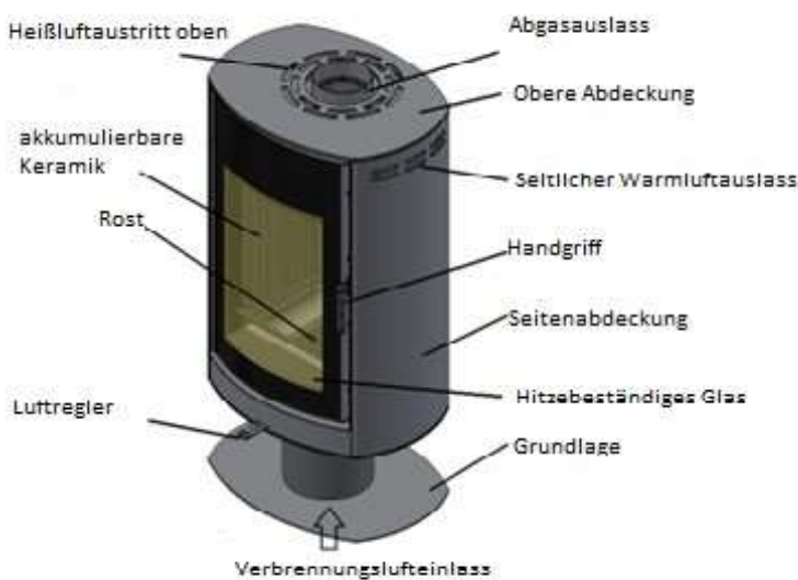
Abb. 2.1. Aufbau des Heizgeräts – Beispiel ARCO F1
